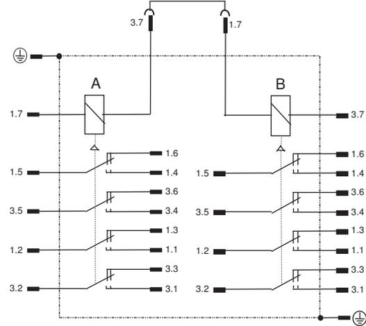
**RELOG - Steckfassung für Schienenschnellbefestigung mit Schraubanschluss bestückt mit 2 RH .. Relais**
